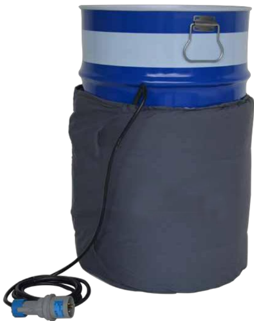
热毯应用于桶和罐，使其表面达到约60 °C。适用于工业过程中使用的油漆，油和液体的温度保持应用。
